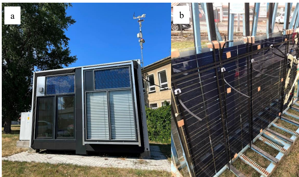
Obr. 3: a – experimentálne zariadenie Twin Rooms; b – fotovoltické sklo
