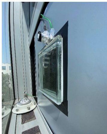
Obrázok 2: Zhotovený tmavý box s umiestnenou vzorkou vystavenou priamemu slnečnému žiareniu
