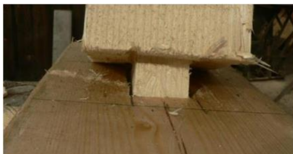
Obrázok 5: Čapovanie – Spojenie dlabu a čapu [3]
