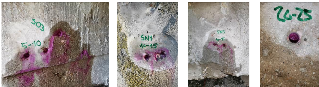
Obrázok 3: Meranie hĺbky karbonatizácie postupným navrtávaním.
