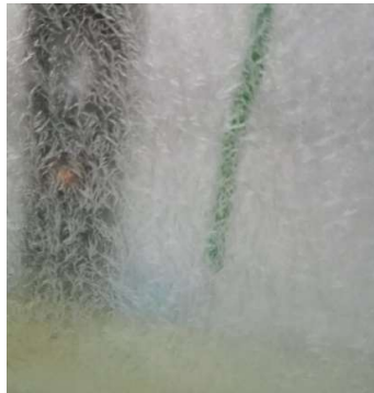
Obrázok 1: Štruktúra prechodnej fázy kryštalizácie parafínu
