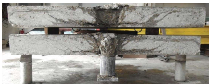
Obr. 3: Priečny rez porušenými vzorkami [5]
