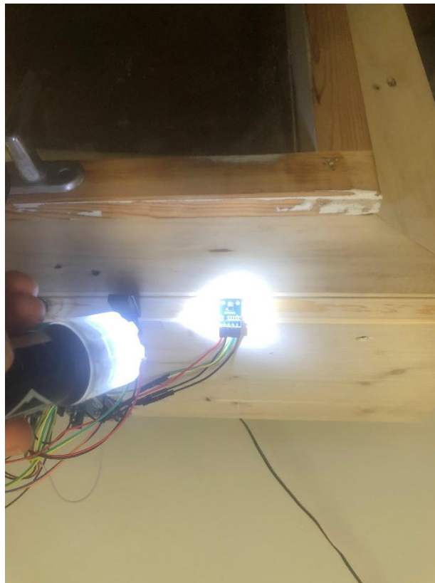
Obr.4 Narušenie medzných hodnôt LED svetlom [foto autor]
