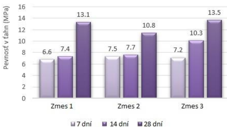
Obrázok 5: V grafe sú znázornené pevnosti v ťahu po 7, 14 a 28 dňoch
