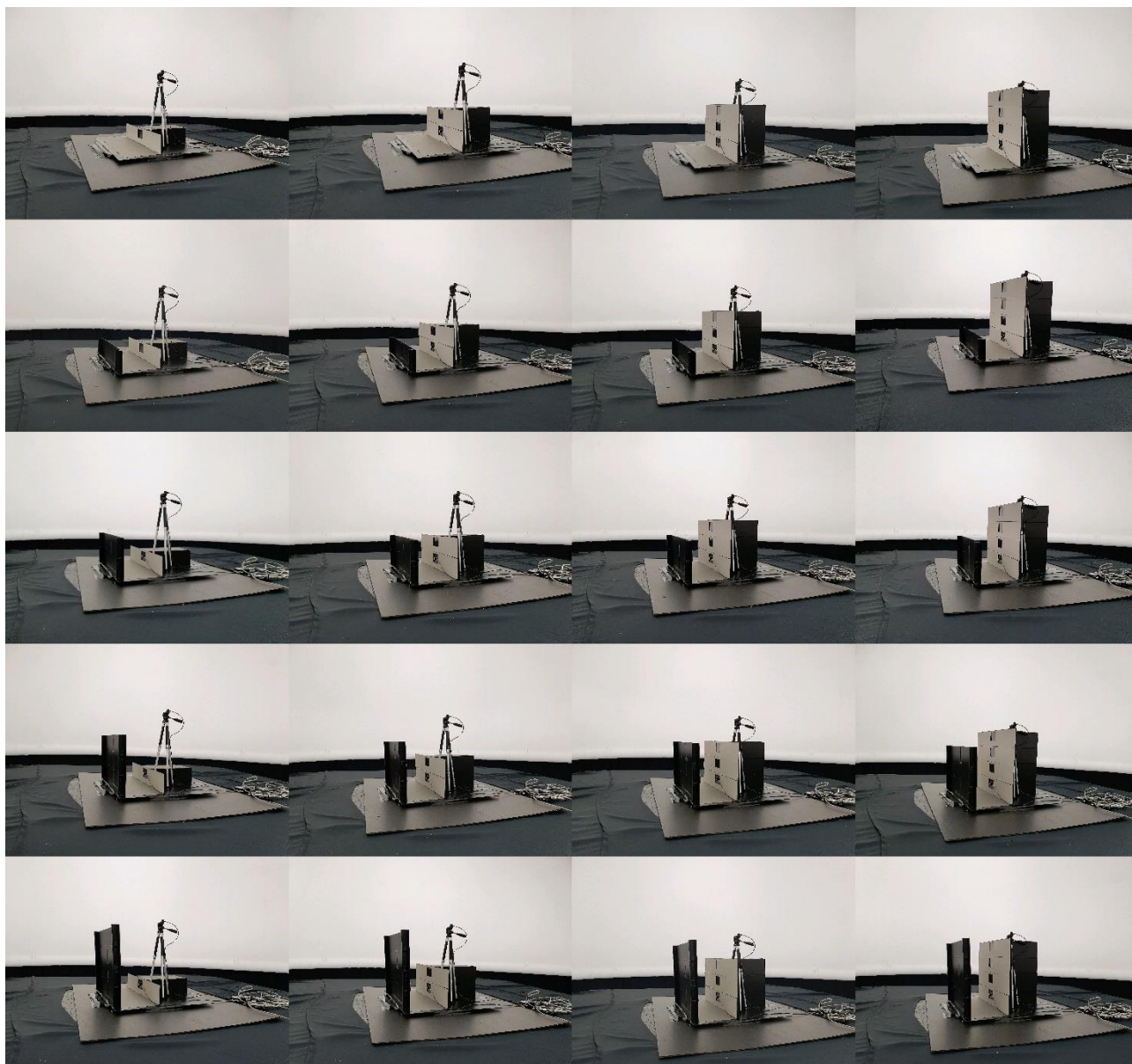
Obrázok 6: Meraná zostava modelovej miestnosti s prekážkou
