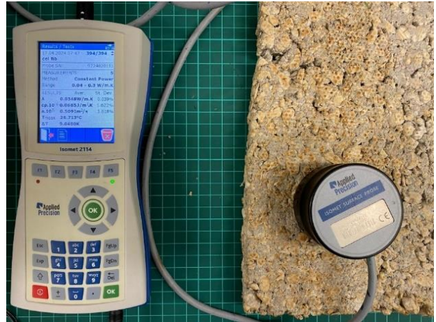
Obrázok 6: Meranie prístrojom Isomet 2114
