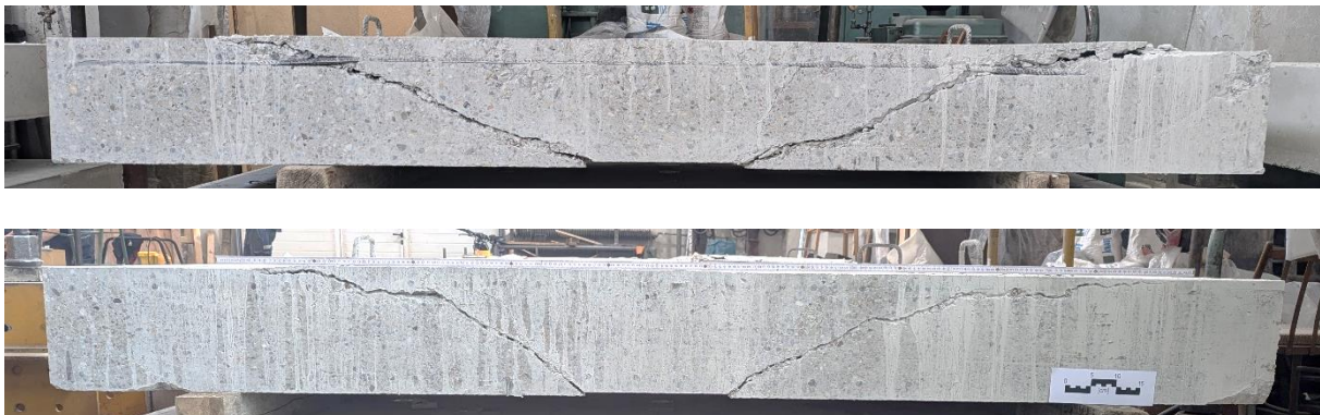
Obr. 5: Porušené a prerezané dosky (hore D1.1, dole D1.2)
