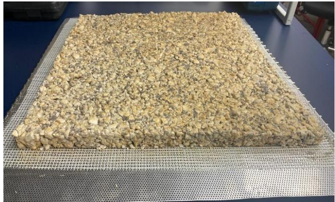
Obrázok 4: Vzorka po vysušení v komore CTS
