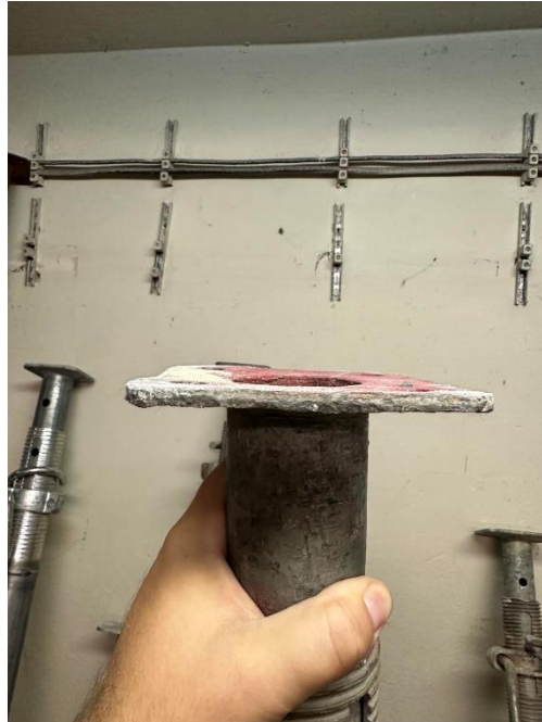
Obr. 2 Ohnutá ocel'ová platňa (Autor)
