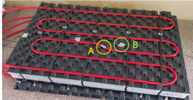
Obrázok 6: Umiestnenie snímačov teplôt [Autor] a) na potrubie, b) medzi potrubiami.
