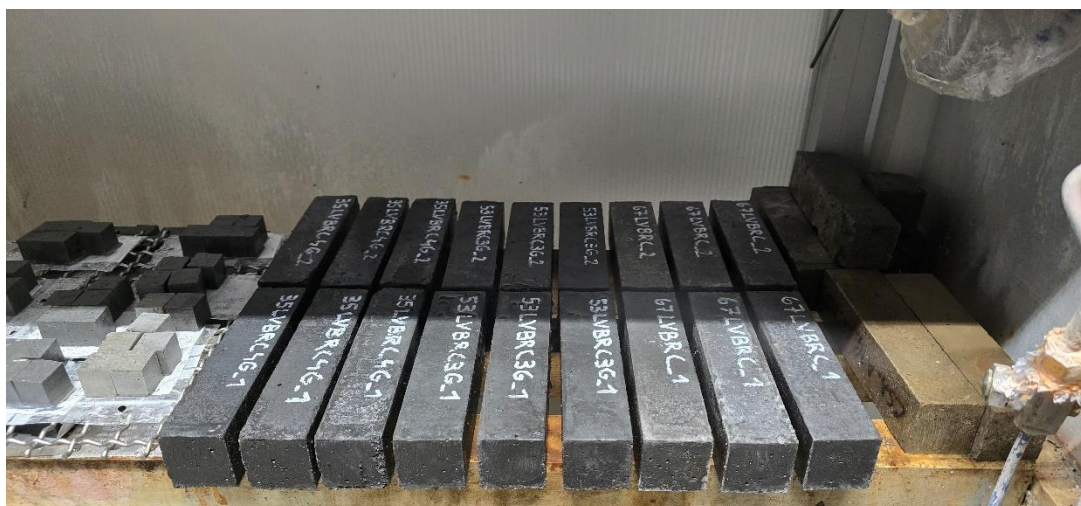
Obr. 3 : Maltové kvádre obsahujúce vitrifikovaný odpad z bauxitu.
