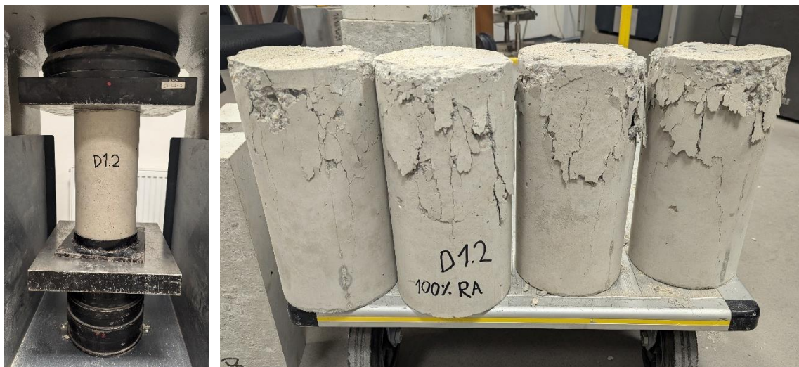
Obr. 3: Skúšanie pevností valcov vzorky D1.2
