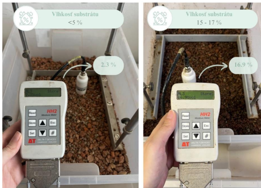
Obr. č. 4 – Meranie vlhkosti vzorky strešného substrátu
