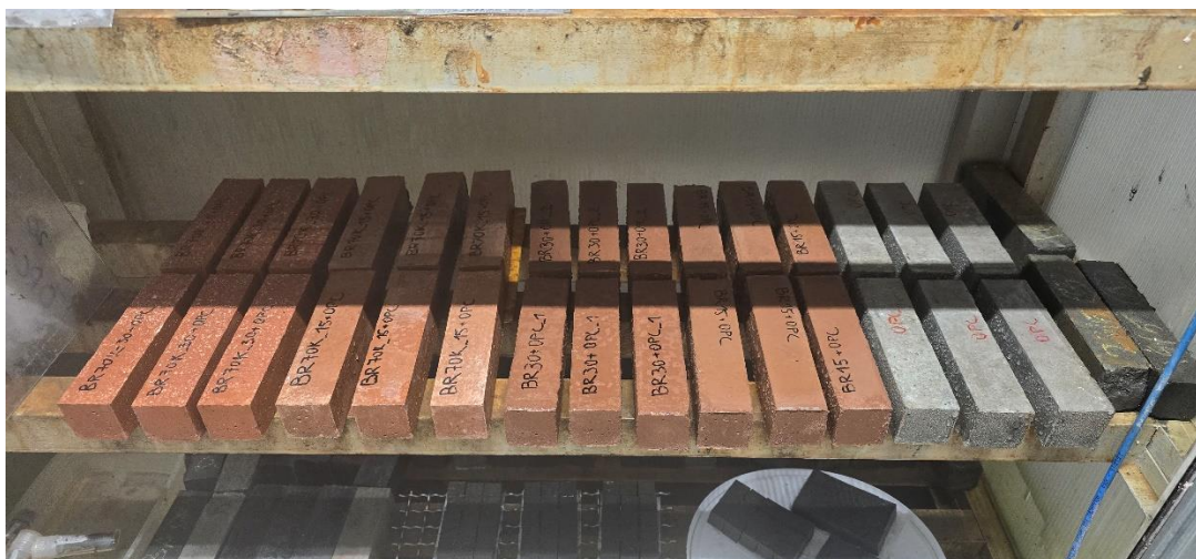
Obr. 2 : Maltové kvádre, z ľava do prava: obsahujúce ko-kalcinovaný odpad z bauxitu, neupravený odpad z bauxitu, štandardizovaná malta z portlandského cementu.
