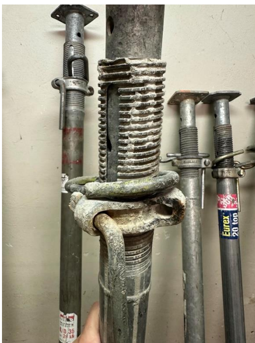
Obr. 1 Znefunkčnený závit na podpere (Autor)
