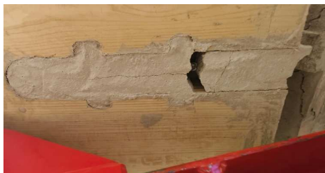
Obr. 23 Poškodenie vzorky D v priebehu testovania.
