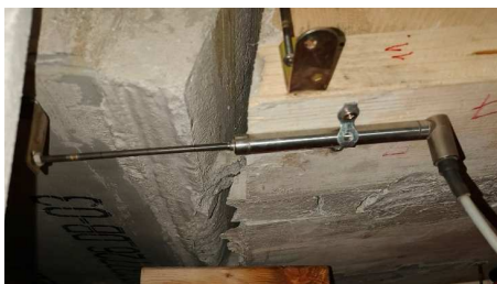
Obr. 22 Záber na vzniknutú medzeru v dôsledku zaťažovania.
