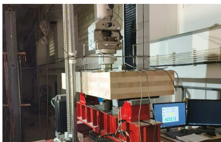
Obr. 20 Osadenie vzorky v skúšobnom zariadení.
