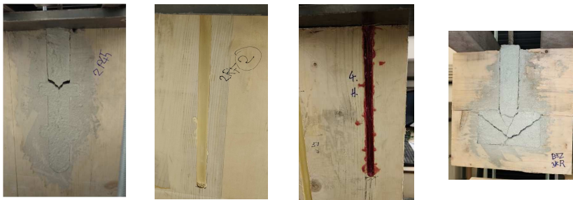
Obr. 19 Vzorky drážok jednotlivých sérii po porušení.
