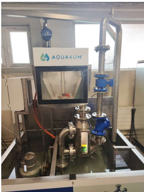
Obr. č. 12 pracovný model PumpProtector vo verzii so zaústením výtláčného potrubia späť do čerpacej bazény
