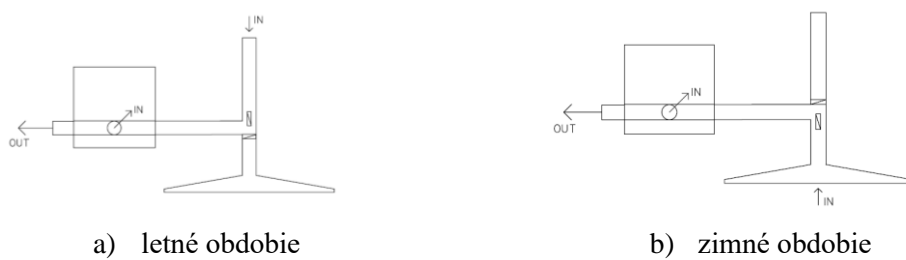
Obr. 9 Schematické zobrazenie prívodu vzduchu do rekuperačnej jednotky a) v letnom b) v zimnom období
