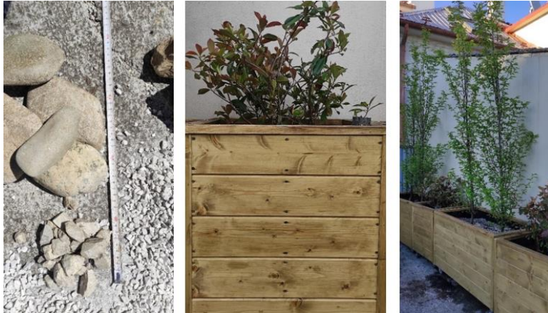
Obr. 4: Frakcie kameniva drenážnych vrstiev, realizácia výsadby (Timea Petrová, 2021)
