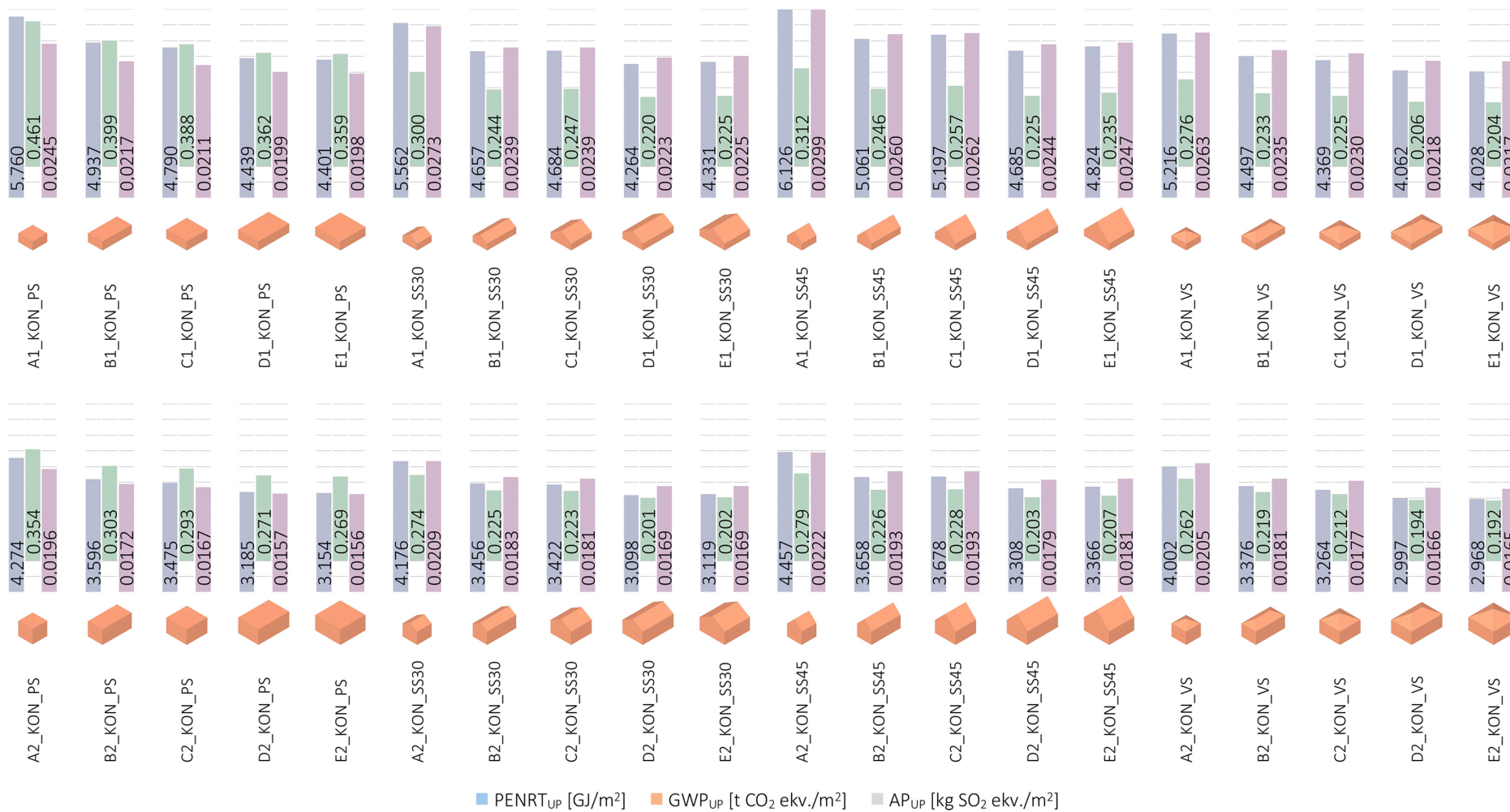
Obr. 1: EI_{UP\_kon} [%] – Environmentálne indikátory na 1m^2 užitočnej plochy A_{UP} všetkých reprezentantov s konvenčnými materiálmi / autor
