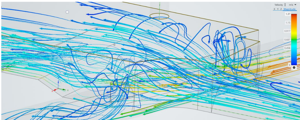
Obrázok 5.133 Simulácia 5 – Detail prúdenia v okolí prepadovej hrany v čase t=600 sek (autor)
